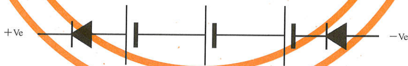
图 E.2 符合 E.4.3 要求的阻塞二极管的安装
